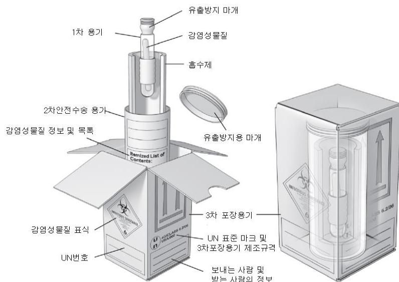
그림 3. 카테고리 A 감염성물질 포장 예시
